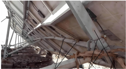
图 1 典型的铝合金光伏支架失效情况 Fig. 1 Typical failure of aluminum alloy brackets
