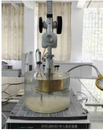
图 1 锥入度试验装置 Fig. 1 Cone penetration test device
