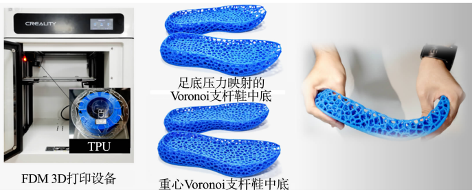
图 11 3D 打印 Voronoi 支杆鞋中底模型
