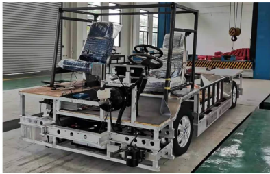
图 6 轮毂驱动平台化底盘试验平台 Fig. 6 Wheel-driven platform based chassis test rigs
