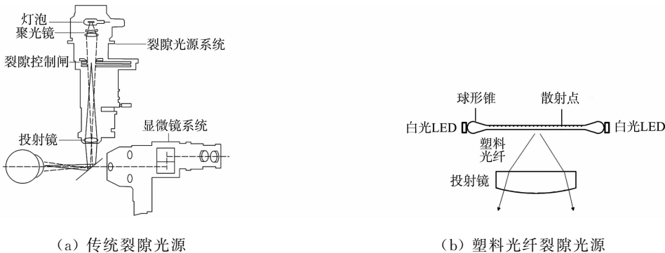
图 1 传统裂隙光源和塑料光纤裂隙光源
