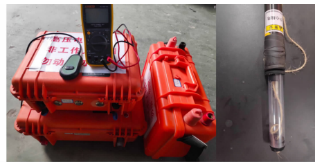
图 15 电火花爆破装置
