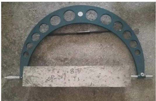
图 3 混凝土收缩仪
