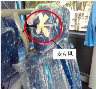
图 1 噪声测试的测点布置
