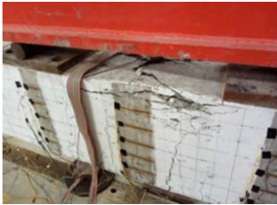
图 9 试验梁 L-2 的破坏形态
