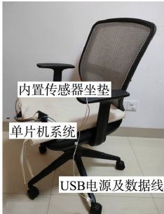
(a) 坐垫内部传感器安装示意图 (b) 体压分布测试系统实物 图 1 坐垫内部传感器安装示意图和体压分布测试系统实物
