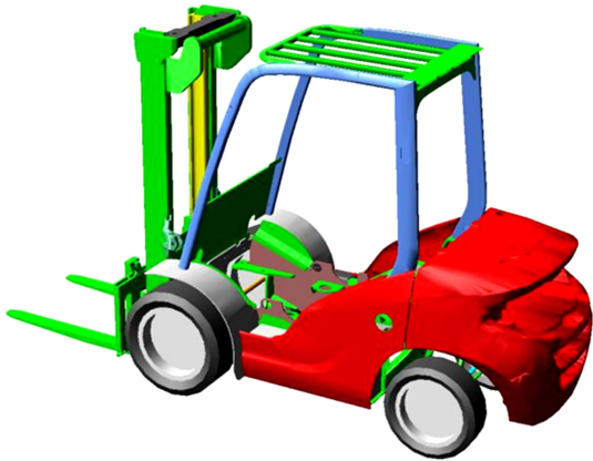
图 1 叉车 ADAMS 横向动力学模型 Fig. 1 ADAMS steering dynamics model of forklift truck
