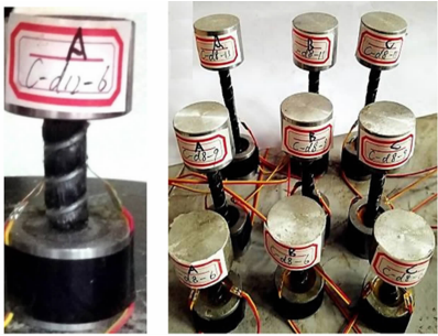
图 2 CFRP 筋压缩试件
