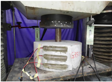
图 2 试验加载装置 Fig. 2 Test loading devices
