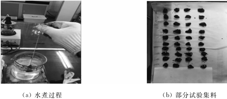
图 1 水煮法的试验过程 Fig. 1 Test process of boiling method 表 4 集料的粘附等级
