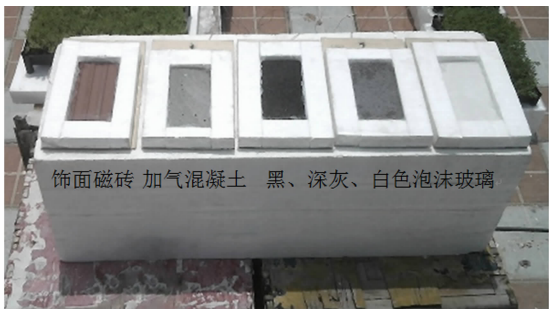
图 3 材料块试件的布置 Fig. 3 Material block layout
