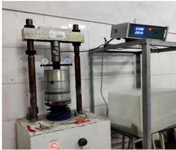
图 11 级配碎石混合料的 CBR 试验仪器
