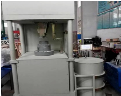
图 2 道路材料振动旋转压实仪 Fig. 2 Road material vibration rotary compaction device
