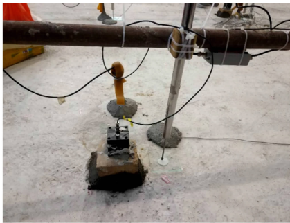
图 3 板面加速度传感器 Fig. 3 Plate acceleration sensor
