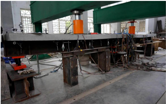
图 2 试件加载装置图 Fig. 2 Loading device of specimen
