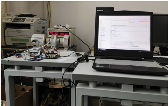
图 5 无刷直流电机转速控制实验装置 Fig. 5 BLDC motor experiment device of speed control
