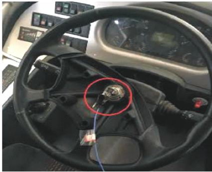
图 6 方向盘三向传感器安装位置 Fig. 6 Installation position of steering wheel three-way sensor
