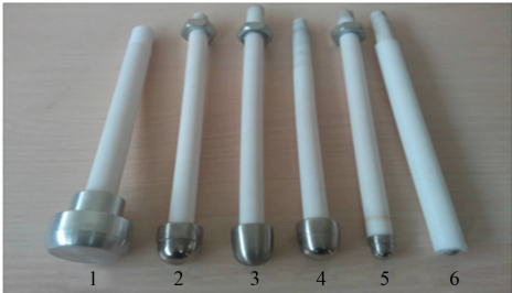
图 3 6 种体积的悬浮放电模型 Fig. 3 Six size of suspension discharge model
