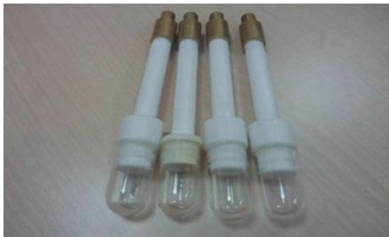
图 4 金属颗粒放电模型 Fig. 4 Metal particle discharge model
