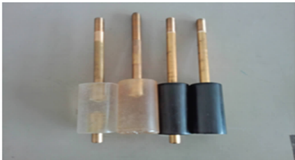
图 2 不同材质的气隙放电模型 Fig. 2 Different materials of air gap discharge model
