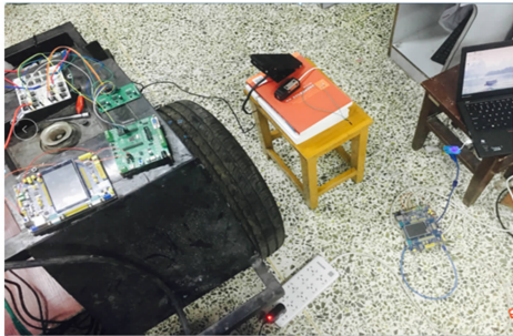
图 7 电机驱动控制测试平台
