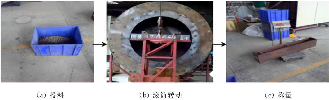
图 3 单个叶片滚筒实验流程图 Fig. 3 Single blade roller experiment flow chart
