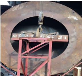
图 1 单个扬料叶片滚筒实验台
