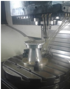
Fig. 14 Rough milling 图 14 粗铣
