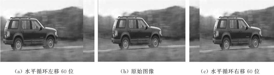
图 1 构造循环结构示意图 Fig. 1 Cycle structure diagram
