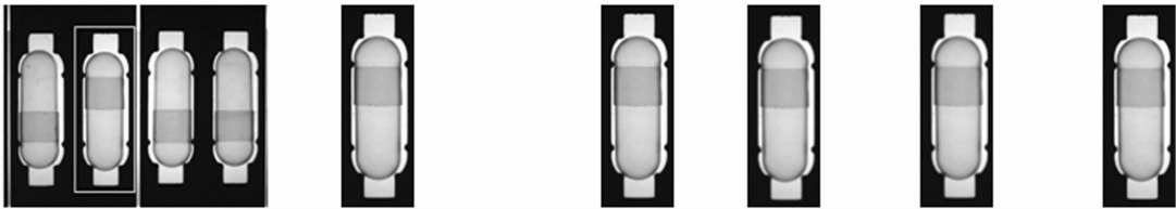
(a) 原始图像 (b) ROI 图像 (a) 原图 (b) 均值滤波 (c) 高斯滤波 (d) 中值滤波 图 2 胶囊图像 ROI 设定示意图 图 3 滤波算法效果
