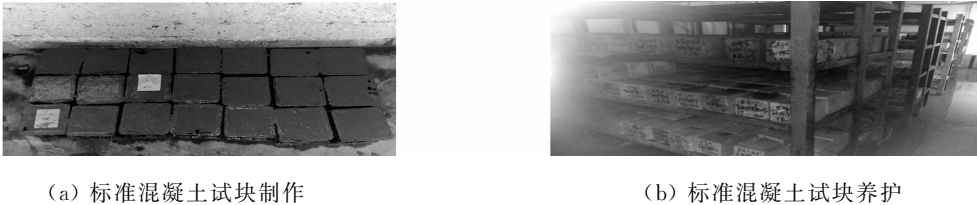
图 1 标准混凝土试块制作及养护
