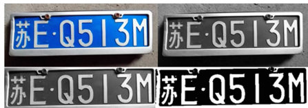
图 2 车牌字符图像的预处理效果 Fig. 2 Preprocessing effect of license plate character image
