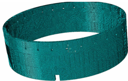
图 2 土楼夯土结构模型的网格划分
