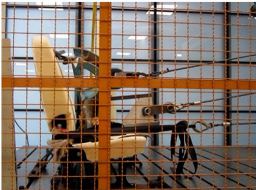
(a) 座椅安全带固定点试验
