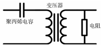
图 2 耦合电路 Fig. 2 Coupling circuit
