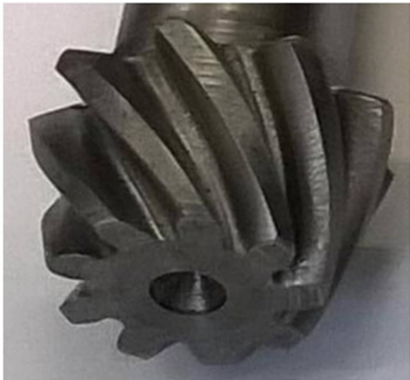
图 9 小齿轮加工样件
