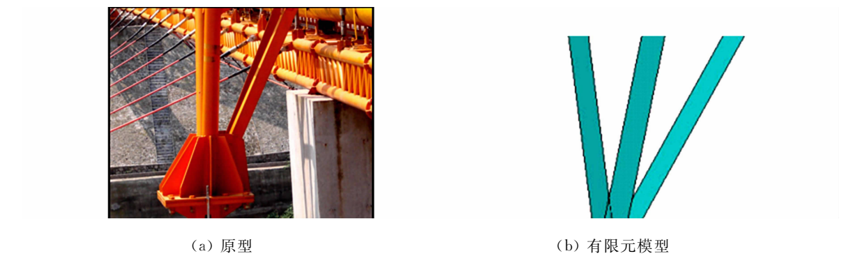
图 2 主塔支座原型与有限元模型对比
