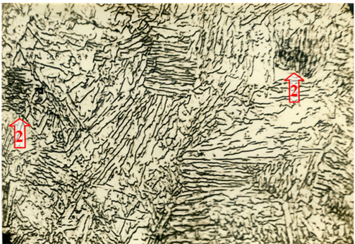
(a) 500\text{ }^{\circ}\text{C} (C 曲线鼻点)等温 5 min
