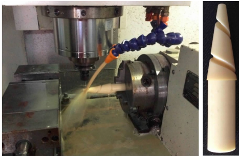
图 5 RRC_{2s^{new}} 类新螺旋曲面实体加工 Fig. 5 Entity processing of new spiral surface on RRC_{2s^{new}} kind
