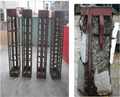
图 6 钢板笼变形图 Fig. 6 Deformation of PCS
