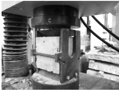
图 2 劈裂抗拉试验装置
