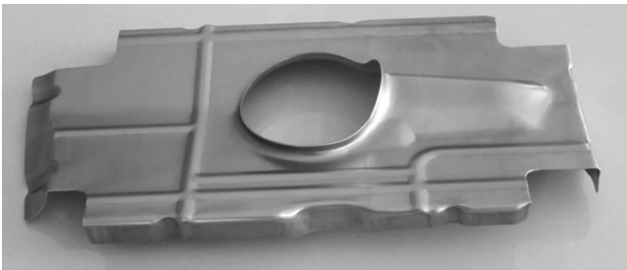
图 4 油箱挡油板 Fig. 4 Oil tank weir
