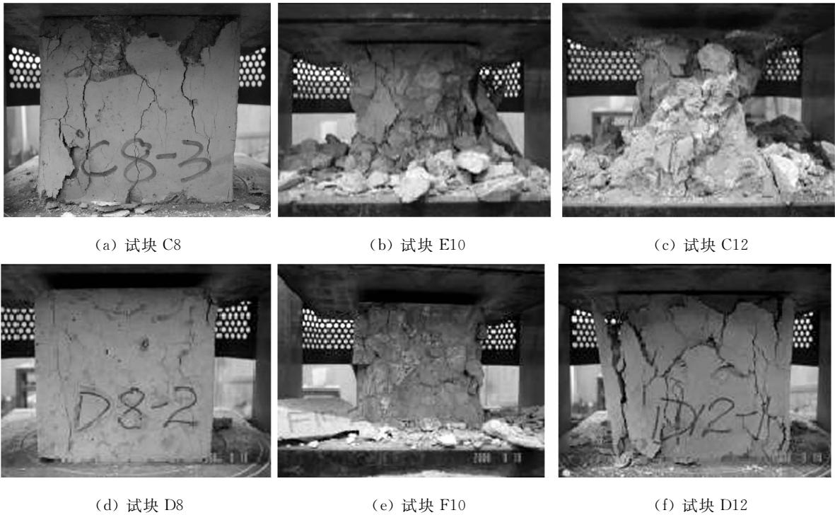
图 2 试块的破坏形态
