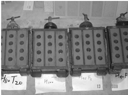
图 1 阴干中的带模砖坯
