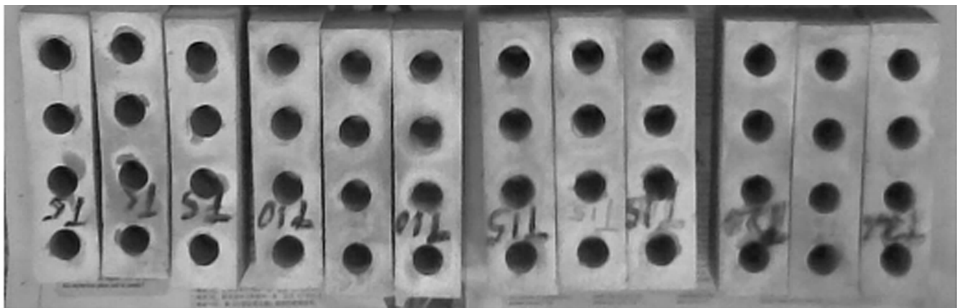
(a) T_5 中等泛霜 (b) T_{10} 中等泛霜 (c) T_{15} 中等泛霜 (d) T_{20} 轻微泛霜
