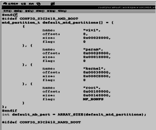
图 1 vivi 的 Flash 分区 Fig. 1 Flash partition of vivi
