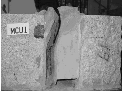
(d) I + X 型破坏(带连接件)
