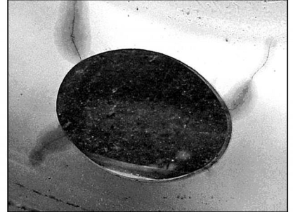
图 7 疲劳试验后的裂纹位置
