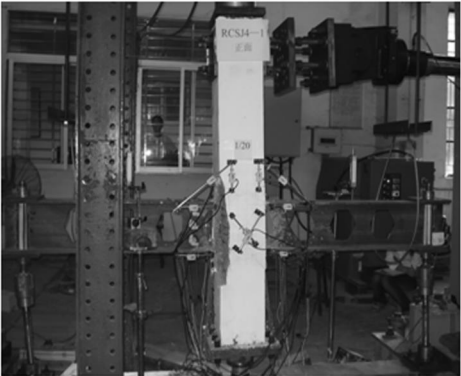
图 2 试验加载装置及测点照片
