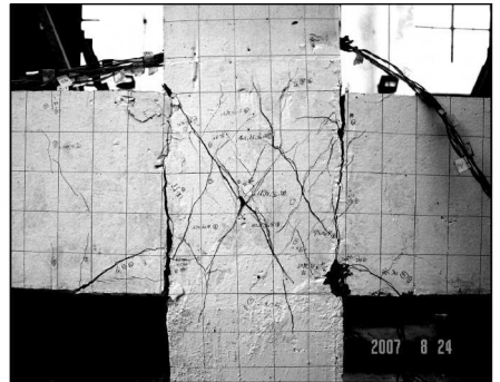
图 1 SRC 节点典型受力变形状态
