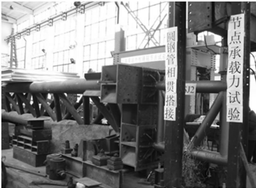
图 3 试验加载装置图 Fig. 3 Test setup
