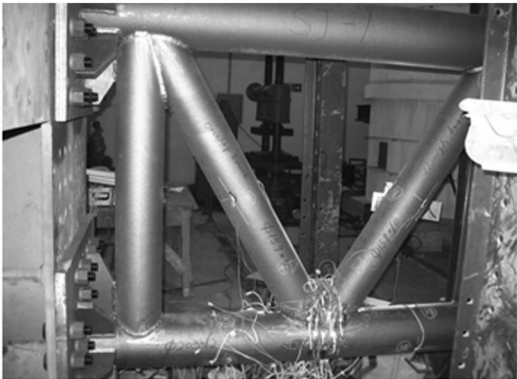
图 4 应变片分布图 Fig. 4 Arrangement of strain gauges
