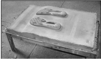
图 10 陶瓷熔射模 Fig. 10 Ceramic spray mould
