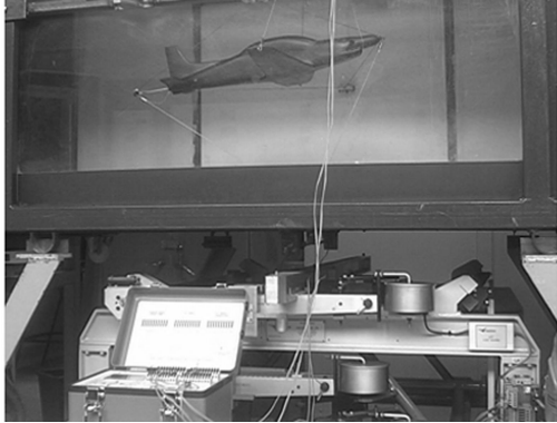
图 2 低速风洞大攻角绳牵引并联支撑系统
