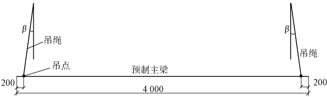
图 6 吊装计算示意图 (cm)
