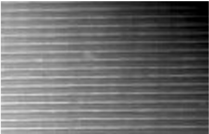
图 6 聚合物矩形光栅的表面图像 Fig. 6 Surface image of the polymer rectangle gratings
